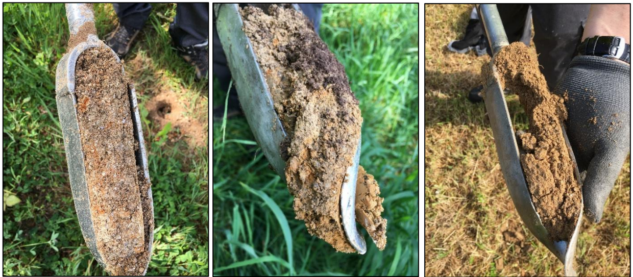
Photos : A gauche : Traces rédoxiques sur le sondage 13 à 50 cm ; Au milieu : Traces rédoxiques sur le sondage 26 à 120 cm ; A droite : Aucune trace sur le sondage 33 à 50 cm.
