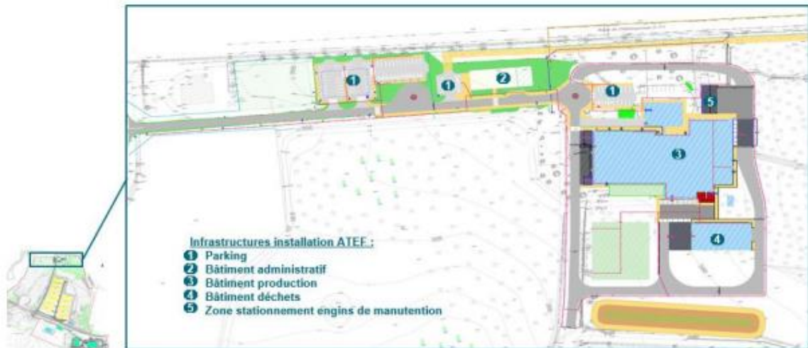
Figure : Implantation de l'installation ATEF sur le site d'ORANO
