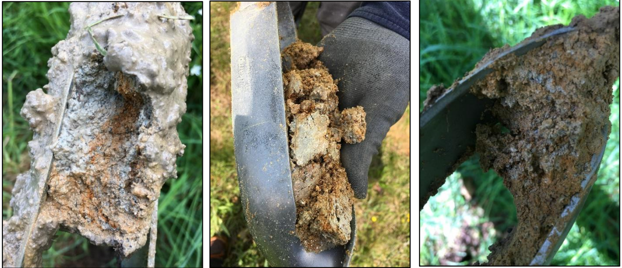
Photos : A gauche : Traces réductiques et rédoxiques sur le sondage 1 à 50 cm ; Au milieu : Traces rédoxiques sur le sondage 6 à 50 cm ; A droite : Traces réductiques et rédoxiques sur le sondage 9 à 120 cm.
